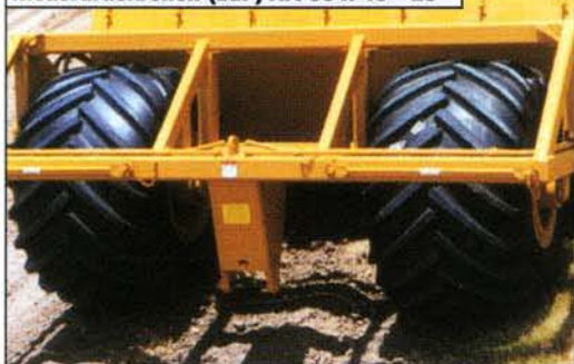
Niederdruckreifen (LGP) Art 66 x 43 - 25
